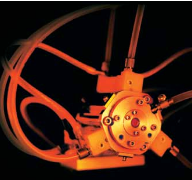
Abb 6: Laserkopf des speziell für die selektive Retinatherapie (SRT) entwickelten Mikrosekunden-Nd:YLF-Lasers
