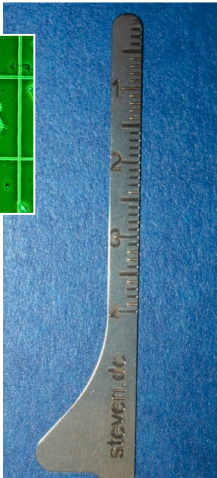
Abb. 4: Markierung eines Fornixlineals zum Einsatz in der Augenheilkunde. Dieses nur wenige 100 \mu m dicke Blättchen einer Titanlegierung darf nur geringer thermischer Erwärmung ausgesetzt werden, um die Rückseite nicht zu verbrennen. Daher wurde, der in Millimetern skalierte Maßstab durch „Kaltablation“ mit einem Excimerlaser eingebracht.
